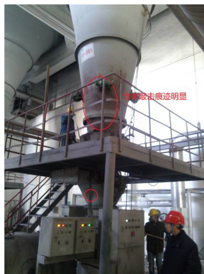
图 1 煤仓堵煤的照片图
