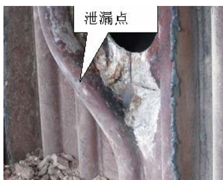
图2 4号炉R19吹灰器让管泄漏点
