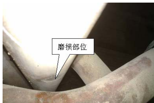
图5 前后屏过热器冷却定位管与前后屏磨损
