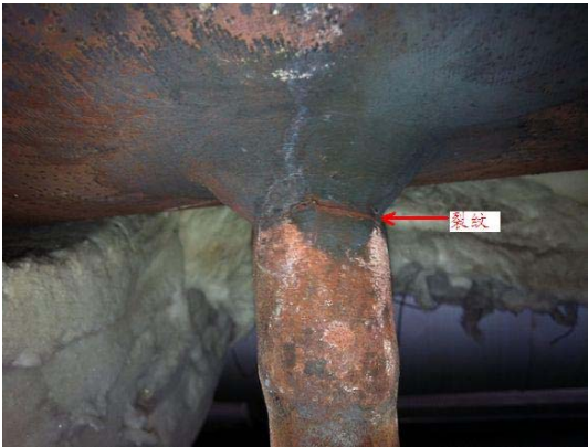
图 3 #5 炉 B 侧高再集箱疏水管座裂纹
