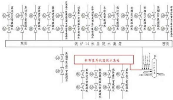
图 7 重新布置的#5 炉一次汽及二次汽疏水
