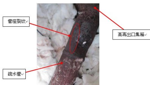
图 1 #5 炉 A 侧高再集箱疏水管座裂纹
