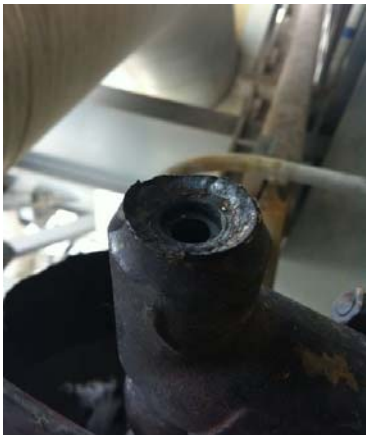
图 4 #5 炉主蒸汽取样一次阀连接管道焊口开裂
