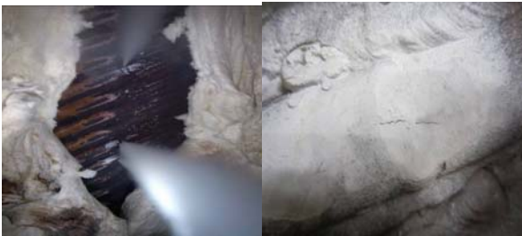
图 1 泄漏裂纹
