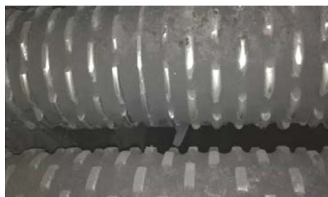
图 1 滚轴筛磨损较严重、间隙大
