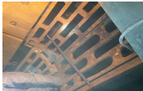
图 2 碎煤机出口篦板孔隙大超标
