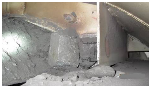
图 3 卡在给煤机入口的石块
