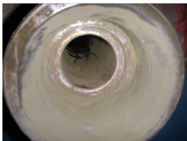
图 1 磨损的推杆轴衬
