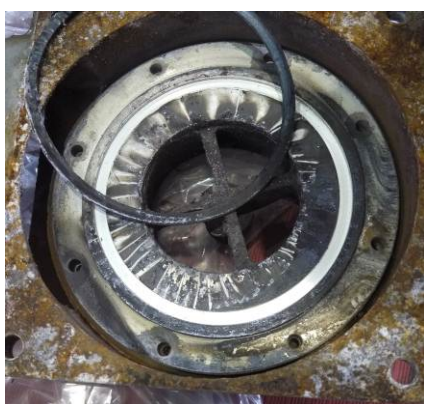
(b) 压接正常的防爆膜
