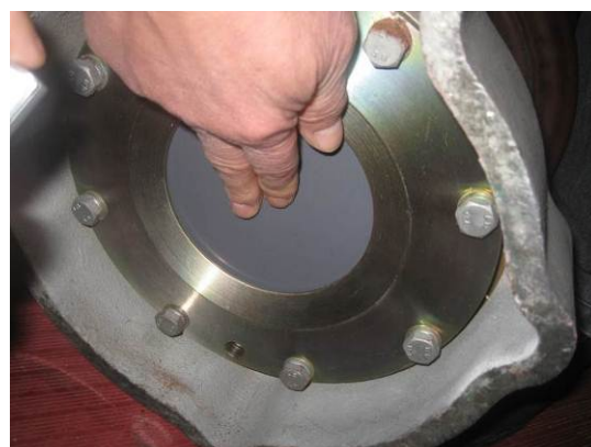
(a) 防爆膜存在缝隙
