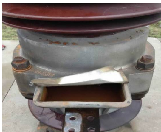
图2 下法兰无排水孔积水示意图
