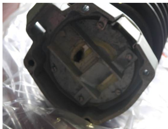
图7 防爆膜破损示意图
