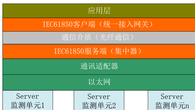
图2 电力物联网信息模型架构图
