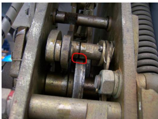
图 1 断路器在储能过程中凸轮碰到分闸扇形板
