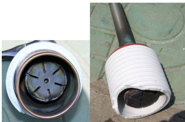
图 2 真空灭弧室动导电杆与导向套之间锈蚀卡死
