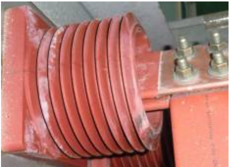
图 9 套管外伞群沿面爬电
