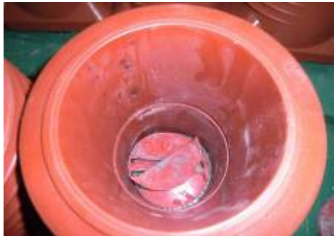
图 8 套管内部放电图
