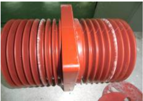
图 10 套管中部伞群放电痕迹
