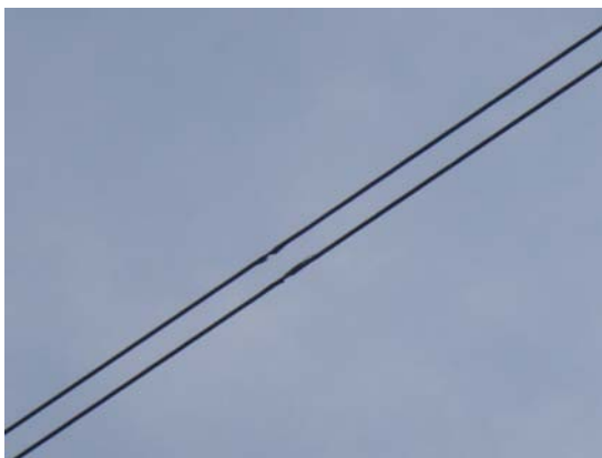
图 1 现场导线断股情况
