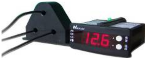
图 4 安装测试霍尔电流变送器
