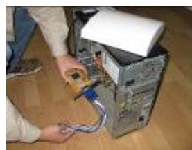
图 15 在后台机内安装以太网卡
