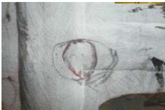
图 3 压力容器丁字焊缝缺陷照片
