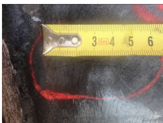
图 5 阀门裂纹缺陷照片
