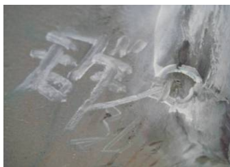
图 10 除氧器低压给水出口管加强板角焊缝气孔照片
