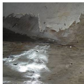
图 13 喷嘴室表面裂纹缺陷照片
