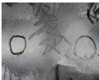
图 6 汽缸外表面裂纹缺陷照片
