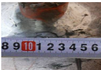
图 9 辅助蒸汽联箱管座气孔照片
