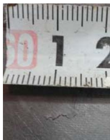
图 7 汽缸结合面裂纹照片
