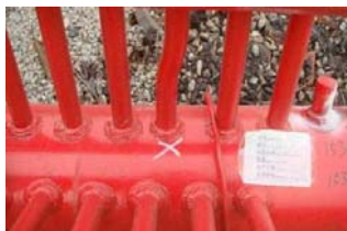
图 11 开孔位置与图纸不符照片
