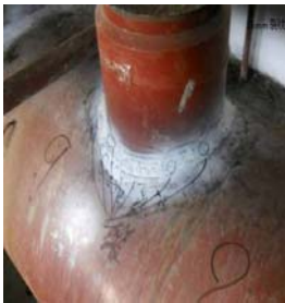
图 2 压力容器管座裂纹照片
