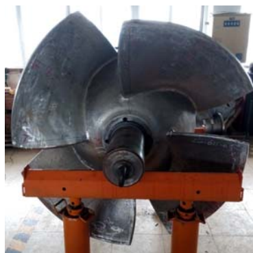
图 2 循环泵叶轮
