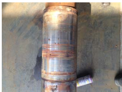
图 6 磨损的轴承套
