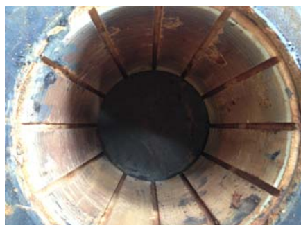
图 7 磨损的导轴承
