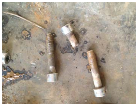
图5 断裂的轴套管螺栓
