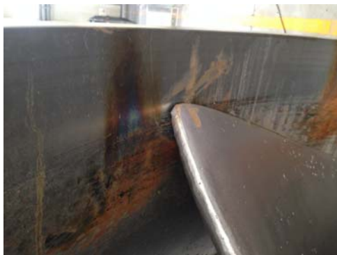
图 9 导叶体和叶轮摩擦发热痕迹
