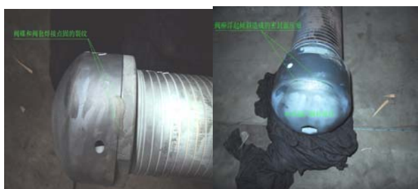
图5 #4高压调节汽阀阀碟
