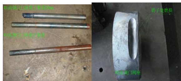
图6 #2高压调节汽阀阀座及阀座销子
