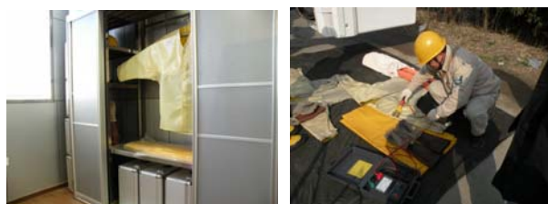
图 4 绝缘工器具的检查
