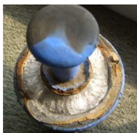
图4 自爆后玻璃绝缘子残锤(鱼鳞状)
