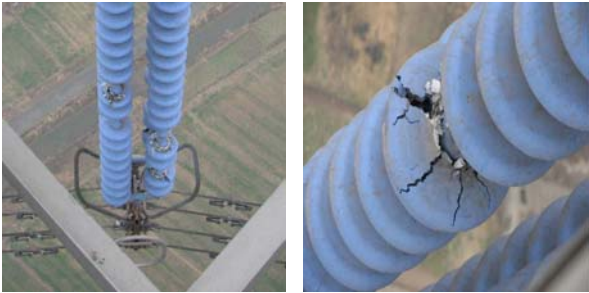
图 1 大跨越线路玻璃绝缘子自爆情况
