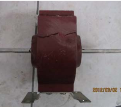
图 5 过热开裂
