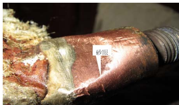
图 2 #4 机第 33 槽定子绕组绝缘引水管三通接头砂眼位置
