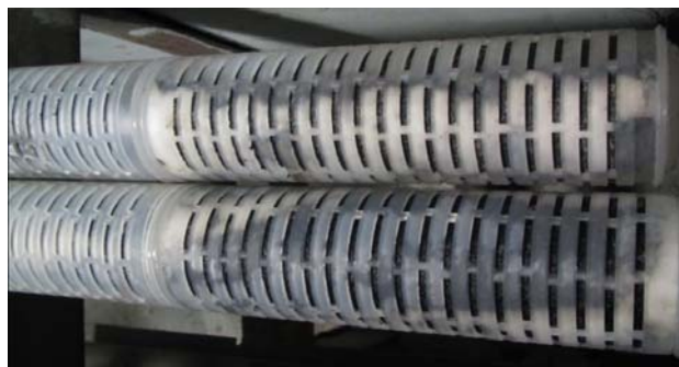
图 7 发电机内冷水滤网滤芯油污图片
