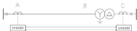
图2 使用光纤差动保护作为线变组的主保护
