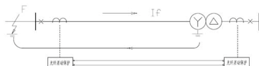
图 5 区外接地故障零序电流流向
