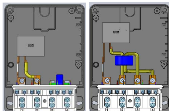
图 1 现有电表内部结构 图 2 本文电表内部结构图
