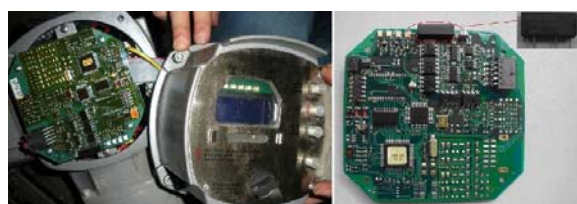
图 15 AUMA 通讯板件及直流隔离器
