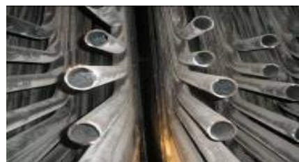
图 5 高再入口管屏氧化皮脱落
