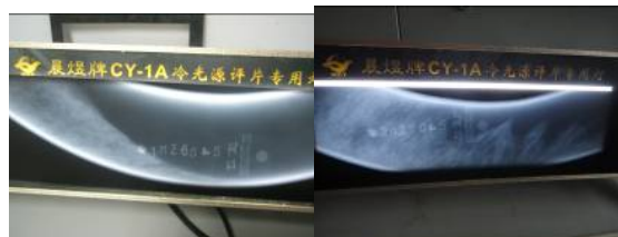
图 3 射线检测氧化皮堵塞
