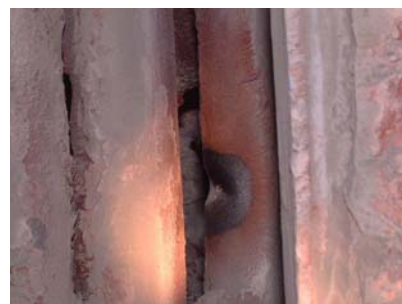
b) 烟道堵塞形成的磨损爆管
