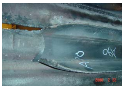
d) 掺烧印尼煤 水冷壁爆管
