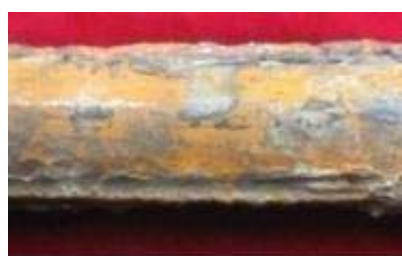
c) 掺烧高硫煤 硫化物腐蚀爆管
