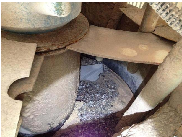
图3 #3 石灰石旋流器溢流口石灰石积聚
