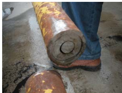
图2 汽化器进口液氨管割管断面
