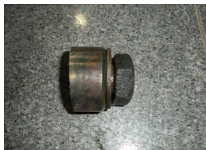
图3 堵住管道螺栓割断后的一段
