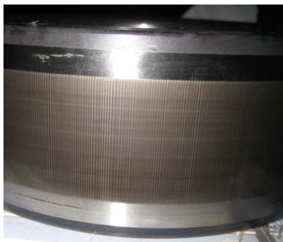
图 1 52 号一次风机轴承套滚道磨损情况
