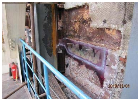
图 11 焊前焊后 PT 探伤
