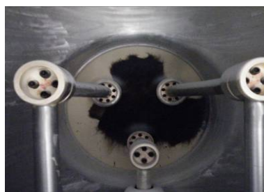
图 1 进线仓盆式绝缘子闪络放电痕迹
