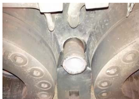
图 1 高压内下缸喷嘴室定位销脱落情况
