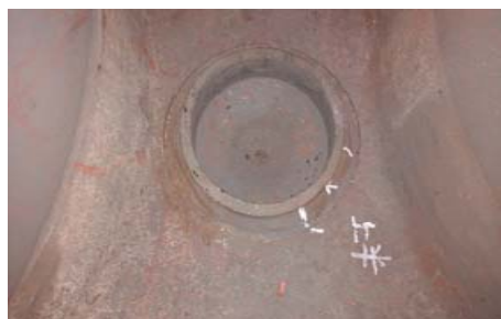
图 2 高压内上缸喷嘴室定位销焊缝裂纹
