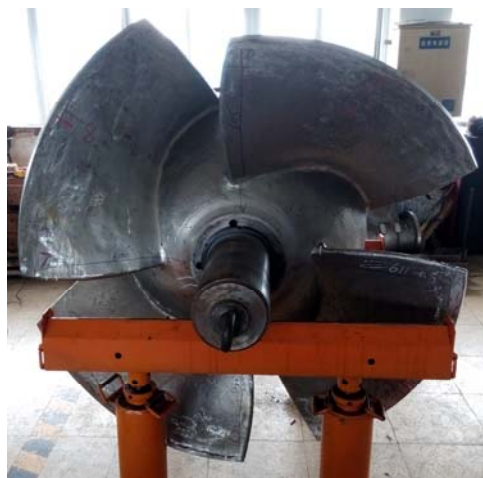
图 7 循泵叶轮
