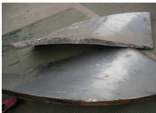
图 4 叶片一只断裂、另一只裂纹
