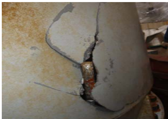
图 5 导叶体破损
