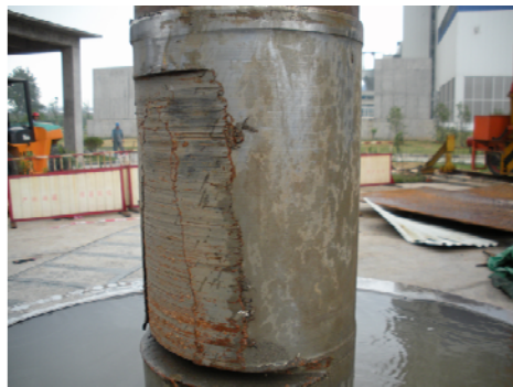
图 2 下轴轴颈磨损
