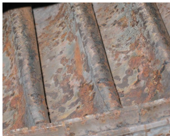
图 3 低压缸腐蚀情况
