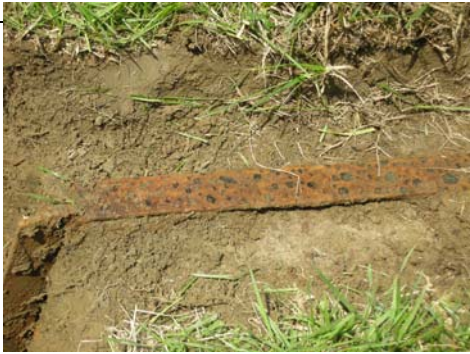
图 2 为水平接地体的腐蚀情况
