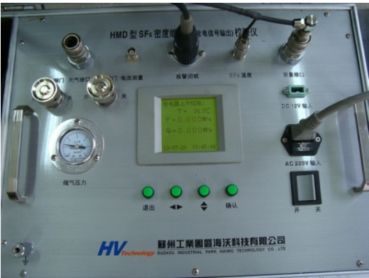
图 3 密度继电器校验仪连接接线
