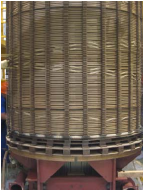
图4 高压绕组C相外观检查正常
