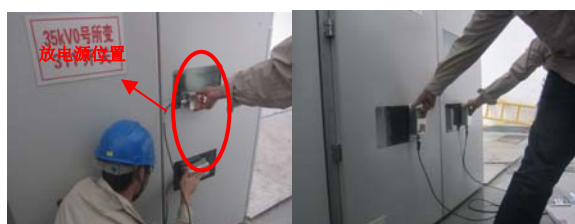
图 12 “35kV0 号所用变 311 开关” 浮电位信号定位照片
