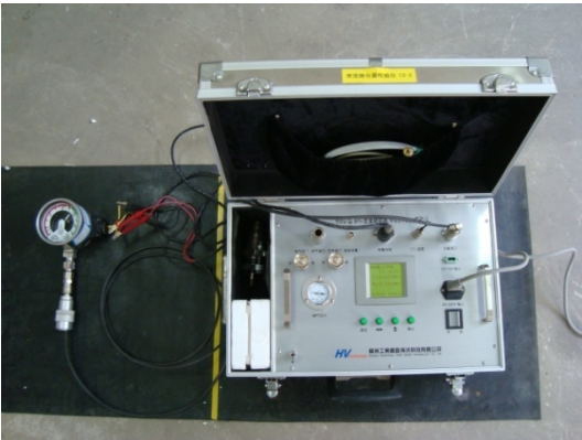
图 2 密度继电器校验连接管路
