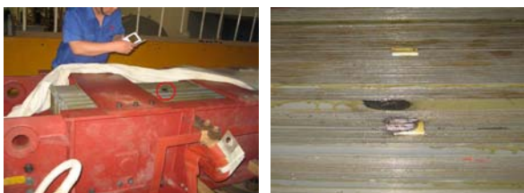
图 2 故障变压器上铁轭表明电弧灼伤
