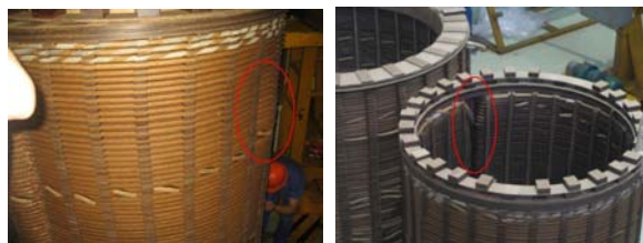
图 4 故障变压器 C 相中压线圈变形情况
