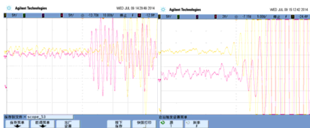
图 16 “35kV0 号所用变 311 开关” 电晕信号定位数据
