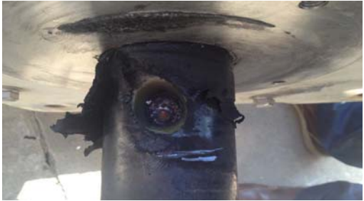
图 2：故障相绝缘击穿点
