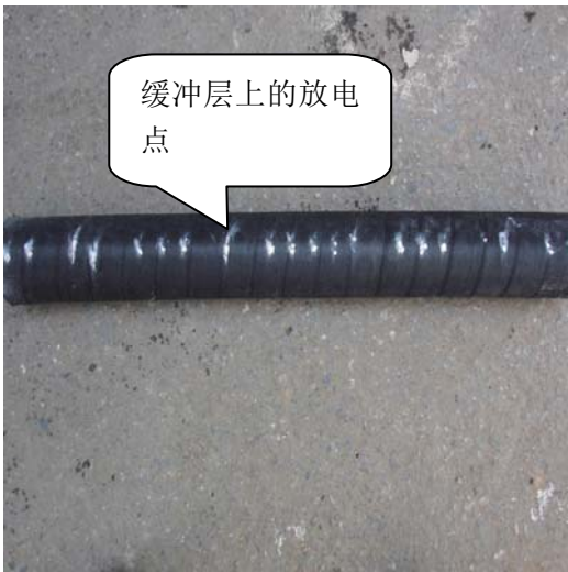
图 3 剥除铝护套后，缓冲层上放电点
