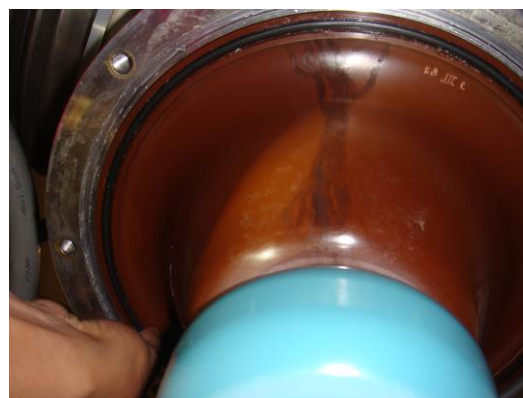
图 1 盆式绝缘子放电痕迹图
