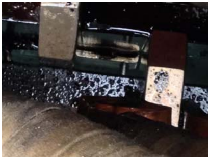
图 2 中压侧 B 相触头烧损情况
