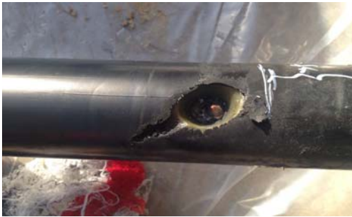
图 3：拆除附件的故障电缆
