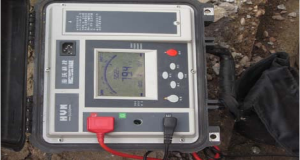
图 7 故障点处测量护套绝缘情况
