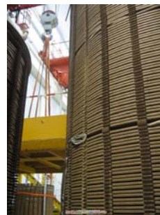
图 5 故障变压器 C 相低压线圈轻微变形
