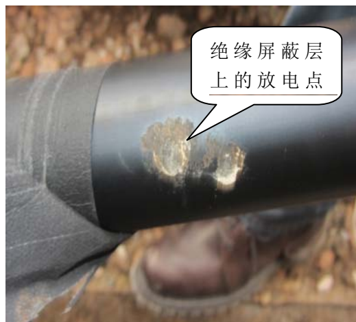
图 2 剥除缓冲层后绝缘屏蔽层上放电点
