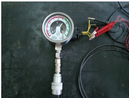
图4 密度继电器 SF6 气路、电气接点接线
