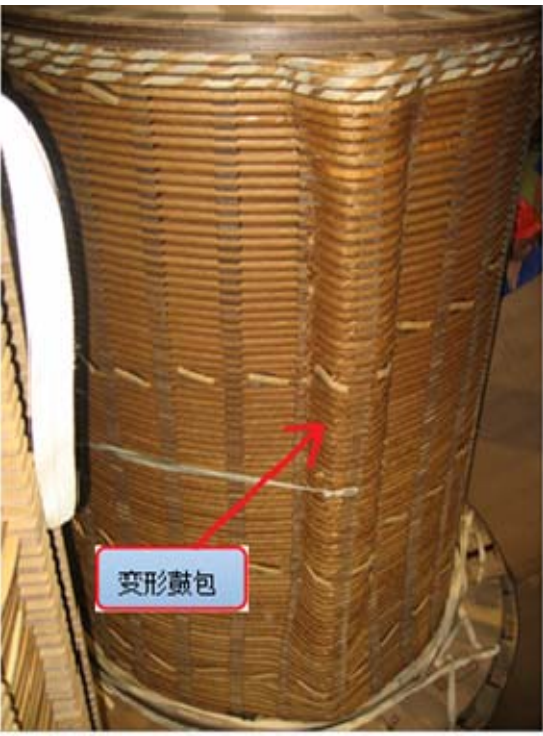
图5 低压绕组C相绕组扭曲、鼓包
