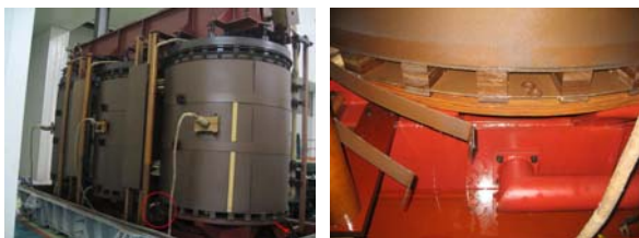
图 1 故障变压器 C 相线圈底部绑扎带脱落
