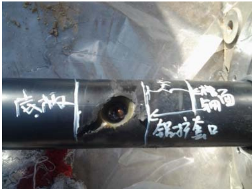
图 4：核实故障电缆的安装尺寸
