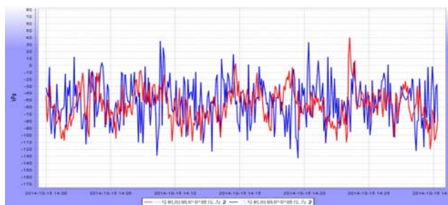
图4 变频调节对炉膛负压自动控制的影响
