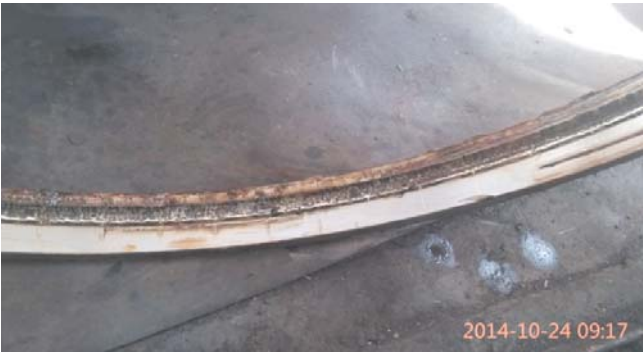
图5 分离器轴承座上轴承滚道磨损严重
