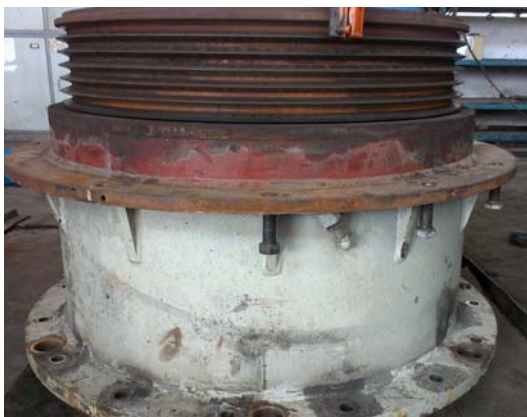
图9 分离器轴承装置
