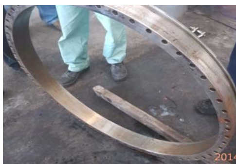
图13 分离器弹簧挡板
