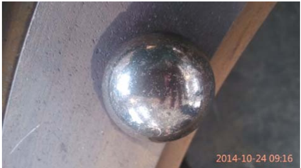
图4 分离器轴承座上轴承滚珠剥皮、变色
