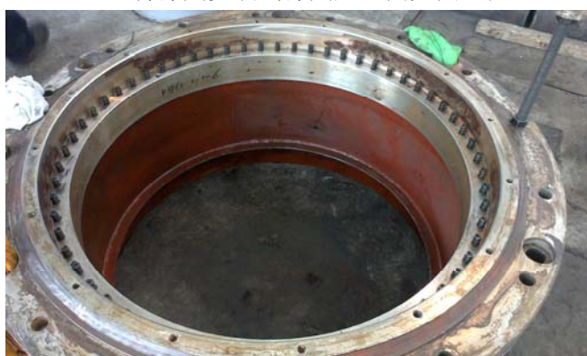
图15 分离器弹簧座安装弹簧
