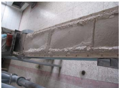
图 4 空气斜槽堵塞情况
