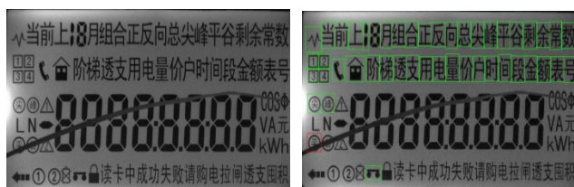
图5 屏幕碎裂时液晶屏原始图及匹配效果图
