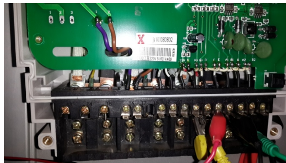
图5 电流进出线之间被加装铜片(三相均有)
