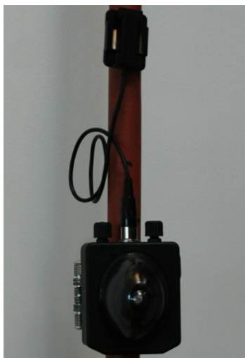
图5 电缆型故障指示器
